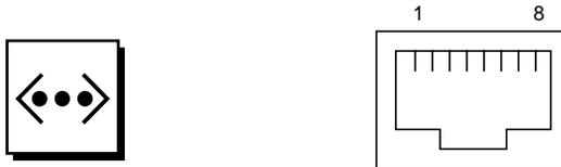
**FIGURE 10-4** RJ45 TPE Socket
