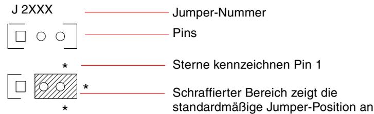
**ABBILDUNG 3-5** Jumper-Kennzeichnung
