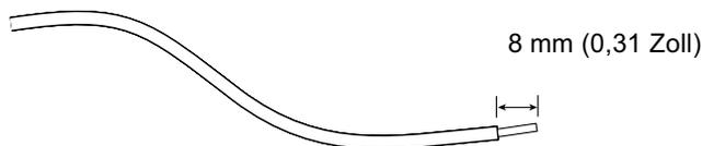
ABBILDUNG 3-2 Abisolieren des Drahtes
