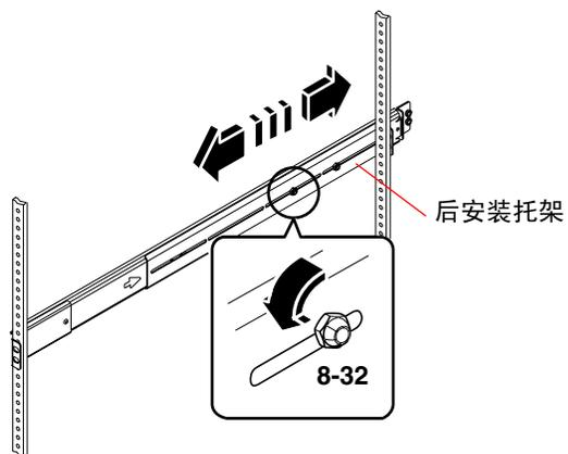
3. 在助手的帮助下，将滑动组件安装到机架前后的立杆上。
