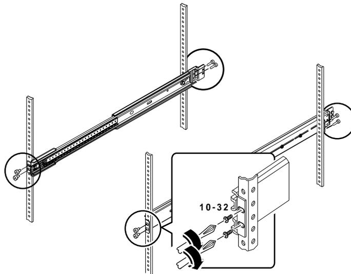
4. 如果机架的深度大于 27.25 英寸（69.21 厘米），请在每个后安装托架上安装一个 8-32 十字螺丝和一个 8-32 锁紧螺母，如图所示。
