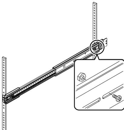
5. 拧紧所有机架安装螺丝。
