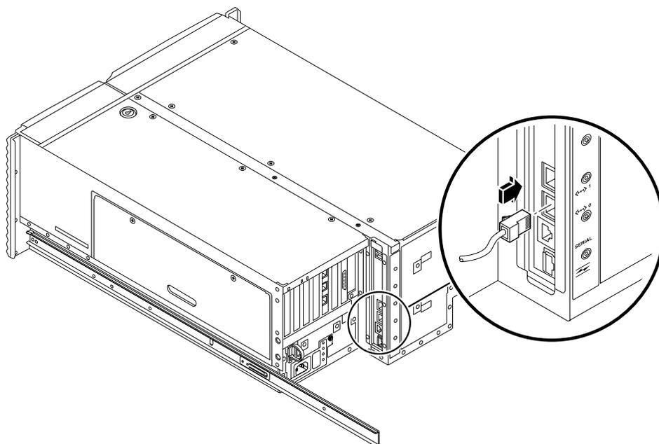
3. 将 TPE 电缆的另一端插入以太网网络的 RJ-45 插座中。
