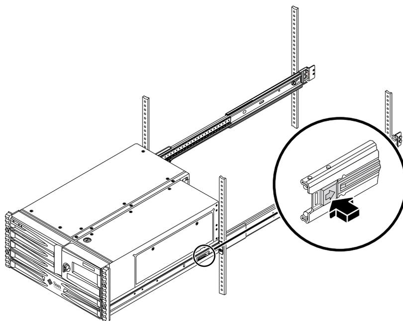
4. 使用装饰板上附带的四颗螺丝，将服务器固定到前面的立杆上。
