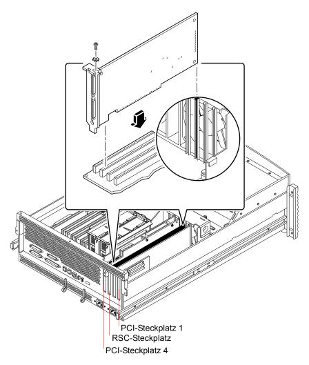
ABBILDUNG 1-12 PCI-Steckplätze des Sun Fire 280R Systems
