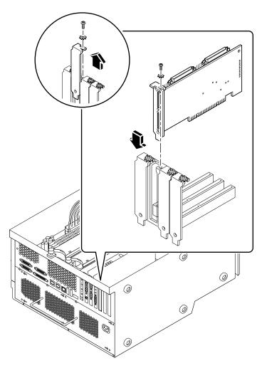
ABBILDUNG 1-6 PCI-Steckplätze des Sun Blade 1000 Systems
