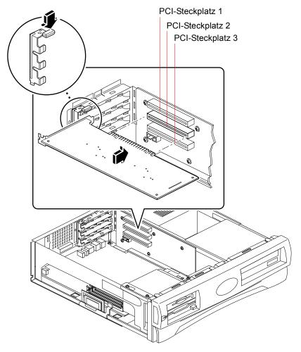
ABBILDUNG 1-7 PCI-Steckplätze des Sun Blade 100 Systems
