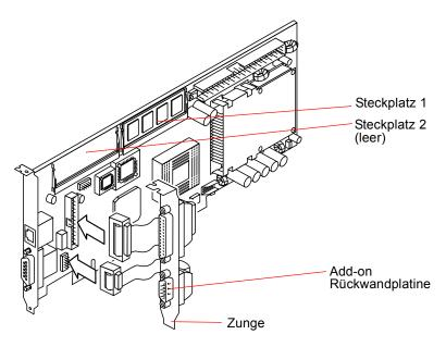
ABBILDUNG 1-1 Anbringen der Add-on-Rückwandplatine
